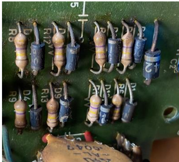
600V を作り出しているダイオードブリッジ
