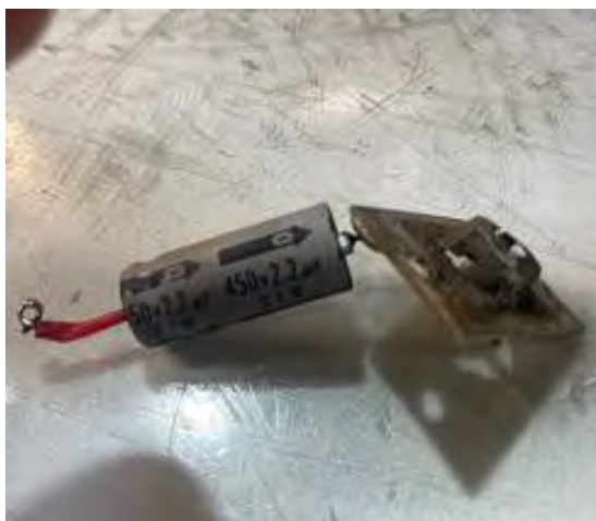
大変外しにくいですが、セパレートにして交換します。
